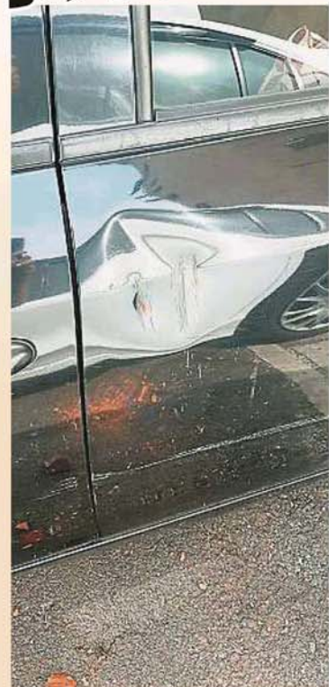
部分轎車的車門被石頭砸中，出現好大的凹痕。
